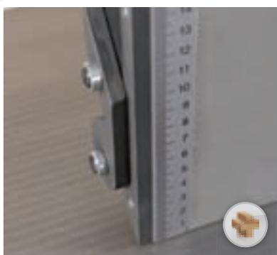
Praktisch: die zusätzliche Skala am Abrichtanschlag.
