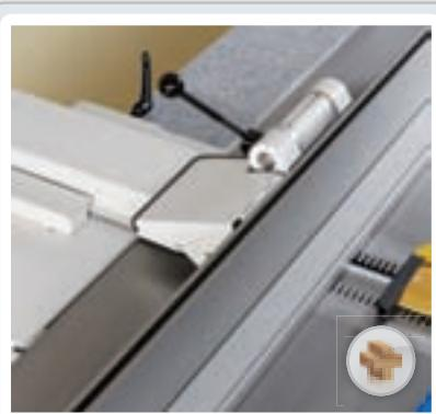
Abrichtanschlag mit leichtgängiger Laufrollenführung für die Gesamtverstellung. Hilfsanschlag ist im Anschlag integriert.
