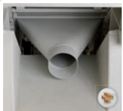
Absaugstutzen im Maschinenständer integriert.
