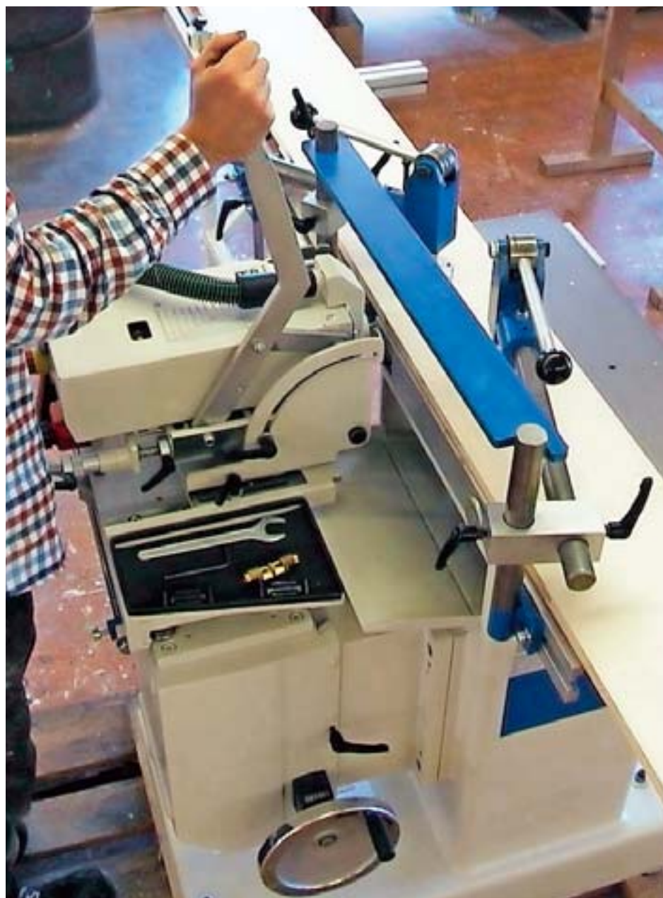
! Mehr als eine Langlochbohrmaschine: Die LB 760-ELA von Hofmann wurde speziell für den ELA-3D-Dübel entwickelt. (Fotos: Lachner)
