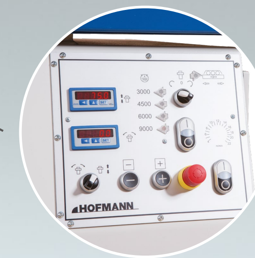
Motorische Verstellung für Höhe und Winkel
