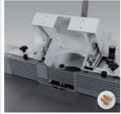
**Fräsanschlag Typ 2610-LED-E / CNC.** Elektrische Verstellung bzw. Positionierung des Anschlags, inkl. zweifacher pneumatischer Klemmung. Exakte Fixierung auch bei schwerster Zerspanung. Abbildung mit Integralanschlagbacken.
