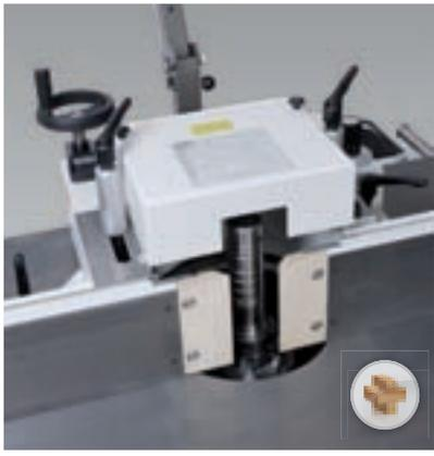
**Fräsanschlag Typ 2601 Effizient.** Gesamtverstellung über Handrad nach Digitalzähler und Einlaufbackenfeineinstellung über Zylinderknopf. Gussanschlagbacken.
