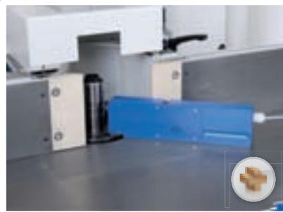
**HOFMANN Pointer** zum Bestimmen des Nullpunkts in der Höhe und Tiefe. Bei Kontakt erfolgt ein optisches und akustisches Signal.
