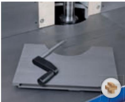
**Tisch mit Tischschieber,** für die schnelle und sichere Einstellung der Tischöffnung. Inklusive Tischeinsatz für Werkzeuge bis Ø 250 mm. Optional Tischeinsatz für Werkzeuge bis Ø 160 mm.
