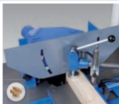
*Schutzhaube für Schiebeschlitten.*
