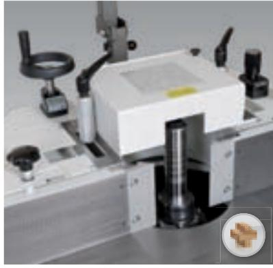
**Fräsanschlag Typ 2610.** Gesamtverstellung über Handrad nach LCD-Anzeige mit Umschaltmöglichkeit auf Werkzeug-Nullmaß. Digitalanzeige für die Einlaufbackeneinstellung. Massiver Anschlag für schwere Bearbeitung.
