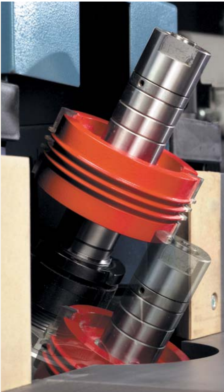
Höhenverstellung ohne Korrektur des Schwenkwinkels. Height adjustment without correcting the swivel angle. Réglage en hauteur sans correction de l'angle de pivotement.
