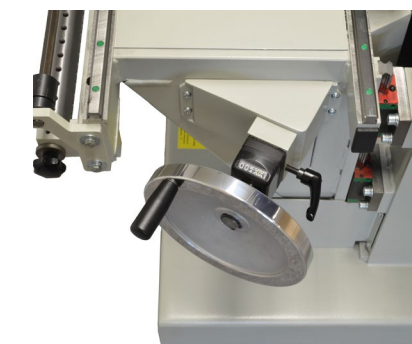
Höhenverstellung nach digitaler Anzeige auf 1/10 mm genau
