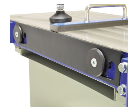
Anschlag auf 3 Höhen einstellbar
