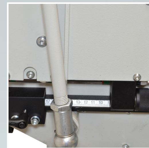
Bohrtiefeneinstellung, Feineinstellung inklusiv
