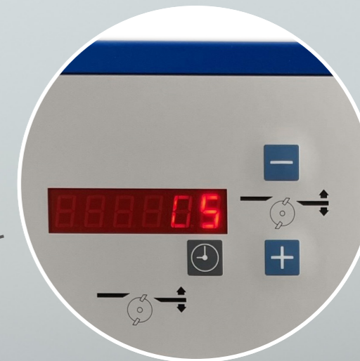
Elektrische Verstellung der Spanabnahme, selbsthemmend
