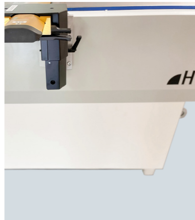
Ergonomisch günstiges Stehen des Bedieners durch Fußfreiheit im Ständer
