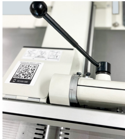
Anschlagverstellung über Einhandbedienung nach Gradanzeige
