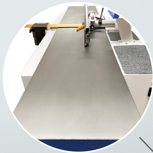
Lange Gusstische (1.500 / 1.500 mm) längsprofiliert (gehobelt)
